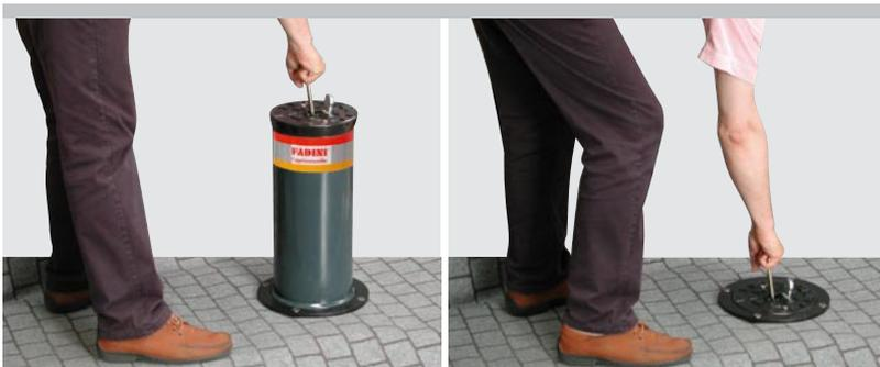
Sblocco manuale: aprire lo sportello di protezione e, dopo aver inserito la chiave di sblocco, girare in senso antiorario. La colonna si abbasserà a livello pavimento. In seguito girare in senso orario la chiave in battuta di chiusura.
